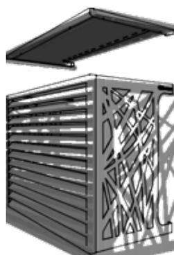
Setzen Sie die obere Abdeckung ein und montieren Sie diese mit den Schrauben. Überprüfen Sie die korrekte Ausrichtung der Platte mit den Seitenteilen.
